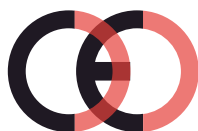
Falsk CE-mærke (for tæt på hinanden)
